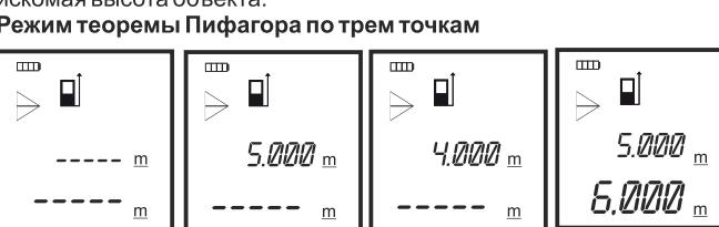
В результате трех измерений – верхней гипотенузы, горизонтального катета и нижней гипотенузы, вычисляется высота отрезка между гипотенузами, позволяя косвенно измерять высоту объектов. Мигающая на дисплее часть треугольника информирует о порядке измерений. После третьего измерения в верхней строке результат третьего измерения (измерения нижней гипотенузы), в нижней строке – размер вертикального отрезка, т.е. искомая высота объекта.
