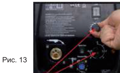
Регуляторы скорости подачи проволоки и силы тока
