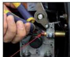
Выходное отверстие механизма подачи
