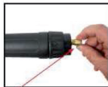
Гайка, фиксирующая канал подачи проволоки
