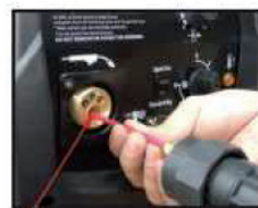
Тefлоновый канал подачи проволоки
