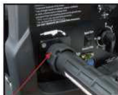
Разъем для горелки MIG
