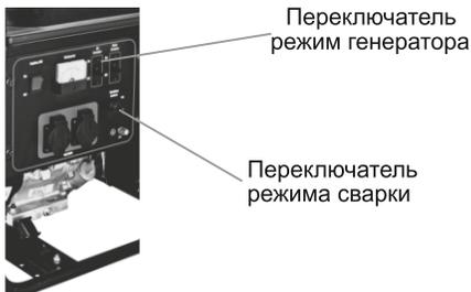
**Внимание! Когда регулятор находится в режиме СВАРКА, напряжение переменного тока является нерегулируемым и имеет значительные колебания.**
