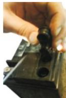
2. Снять крышку и транспортировочную резиновую пробку с суфлирующего устройства.
