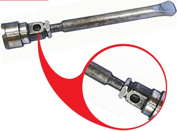
**Заклинивание хвостовика режущей оснастки** в стволе в результате использования некачественных аксессуаров
