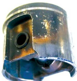
**Выход из строя поршневой группы, вследствие нагара вна поршне,** вызванный низким качеством топливной смеси или повышенным содержанием масла.
