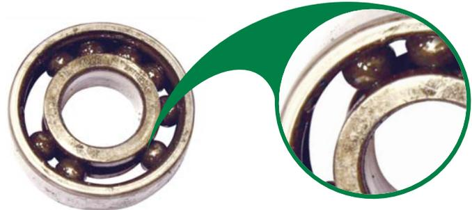
**Разрушение сепаратора подшипника, трещина в обойме подшипника** при условии отсутствия признаков неправильной эксплуатации инструмента.
