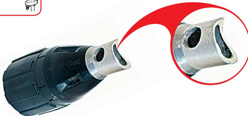
**Механическое повреждение ограничительного упора.**
