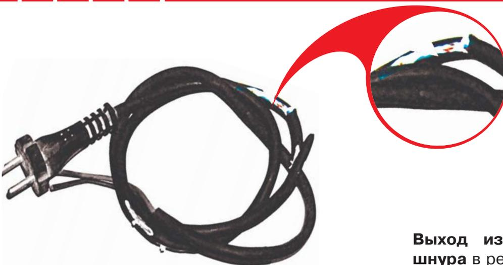
**Выход из строя сетевого шнура** в результате механических повреждений.
