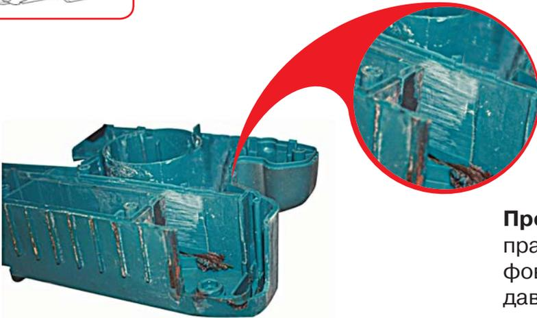
**Пропил корпуса** вследствие неправильной регулировки шлифовальной ленты, чрезмерного давления на инструмент или при использовании шлифовальной ленты неподходящего размера.
