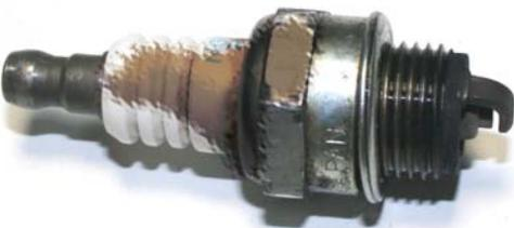
**Выход из строя свечи** из-за образования нагара на изоляторе, вследствие использования несоответствующей техническим условиям топливной смеси, не качественного бензина, не правильно отрегулированного карбюратора.
