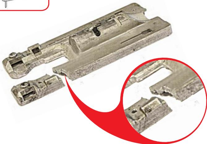
**Механическое повреждение опорной подошвы** в результате удара или приложения чрезмерных усилий при работе.
