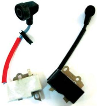
**Отсутствие искры на концевике высоковольтного провода в катушке зажигания.** При условии отсутствия следов попадания влаги, нет поврежденный высоковольтного провода и наконечника свечи.
