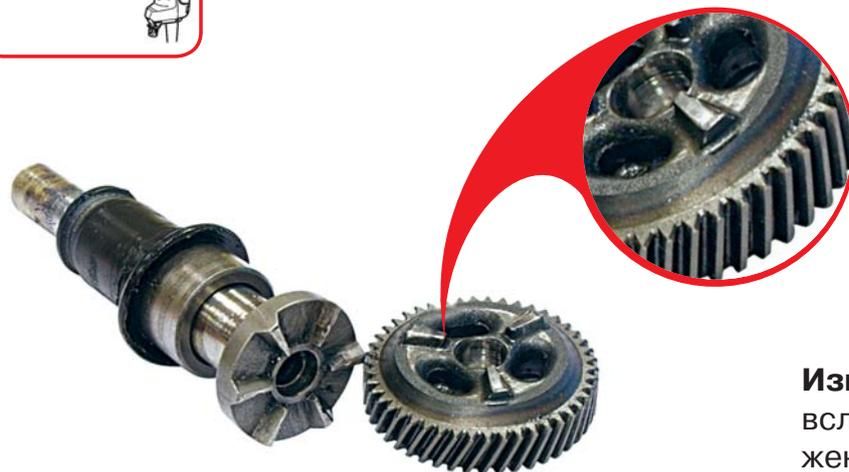
**Износ муфты сцепления** вследствие работы с применением чрезмерных усилий на инструмент.
