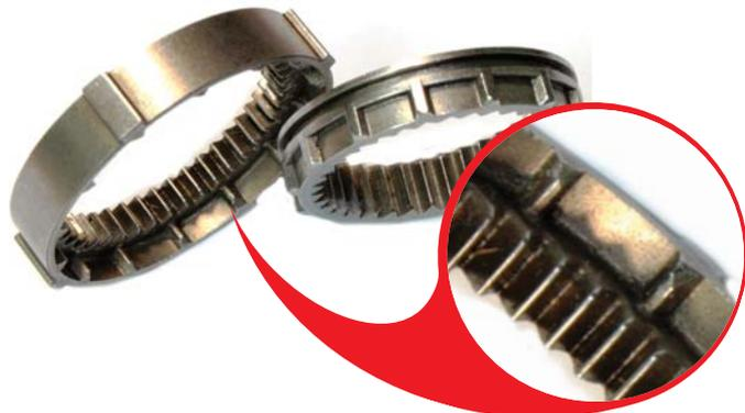
**Повреждение в редукторе рабочих поверхностей стопорных дисков в режиме дрели.** Износ в результате перегрузки.
