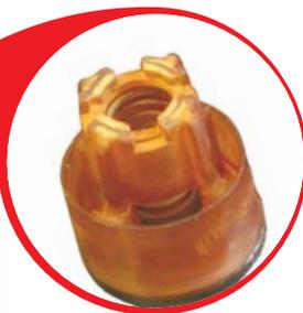
**Износ клапанов, заклинивание подвижных деталей внутри клапана.** Использование неочищенной воды.
