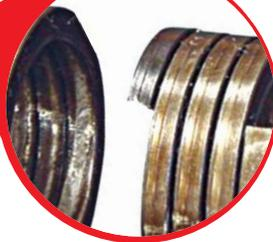
**Разрушение пружины муфты SJS** вследствие частого срабатывания при приложении к инструменту чрезмерного усилия. Перегрузка. Нарушение условий эксплуатации.
