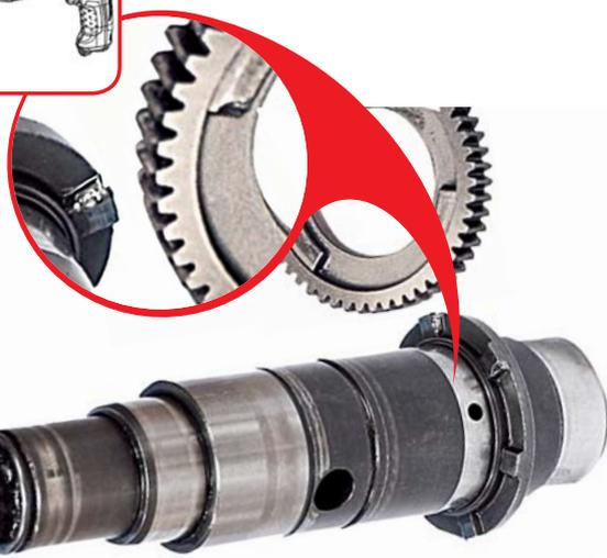
**Степанные блокировочные шлицы предохранительной муфты.** Использование поврежденной режущей оснастки. Размер режущей оснастки больше допустимого для данной модели инструмента. Неправильный прием работы инструментом.
