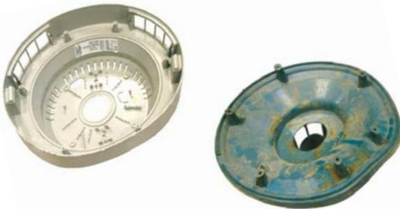
**Деформация корпусных деталей** вследствие перегрева двигателя при не соблюдении правил эксплуатации.
