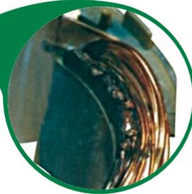
**Выход из строя одной из обмоток статора** вследствие пробоя межвитковой изоляции, пробой на корпус, обрыва в обмотке при условии отсутствия следов механического повреждения. Электрическое повреждение контактов статора. При условии отсутствия следов нарушений условий эксплуатации и перегрузки машины. Ротор не поврежден.
