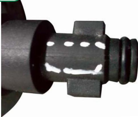
**Трещина в патрубке шланга насоса высокого давления.**
