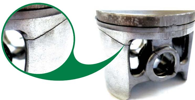
**Повреждение поршня.** Одно из стопорных колец пальца поршня отсутствует. Смещение пальца поршня привело к повреждению.
