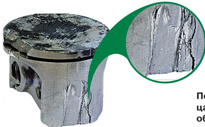
**Попадание стопорного кольца поршневого пальца или обломков игольчатого подшипника между стенкой цилиндра и поршнем.**
