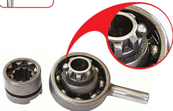
**Степанные блокировочные шлицы муфты сцепления.** Неправильное действие переключателем режимов работы редуктора. Переключение режимов работы редуктора на работающем инструменте.
