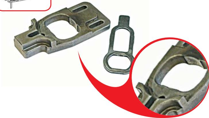
**Износ рабочей поверхности деталей редуктора лобзика** в результате чрезмерного давления на инструмент при работе.
