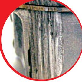
**Выход из строя поршневой группы,** из-за использования не соответствующей техническим условиям топливной смеси, неправильно отрегулированного карбюратора, работой на повышенных оборотах, поврежденным топливным фильтром.
