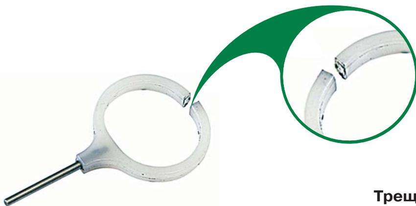
**Трещина плунжера масляного насоса** при соблюдении условий эксплуатации.
