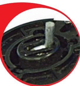
**Повреждение переключателя** вследствие переключения режимов работы в работающем инструменте или попыток высвободить заклинивший бур, используя инструмент как рычаг.
