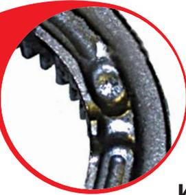
**Износ фиксирующих зубцов опорной шайбы ограничительной муфты.** Износ в результате частого срабатывания, неправильной установки ограничителя муфты скольжения режима шуруповерт.
