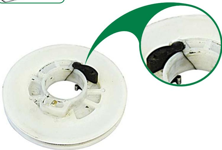
**Трещина катушки стартера.** если не повреждено посадочное место шпонки на маховике.
