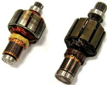
**Выход из строя ротора** в следствие проворота или сползания крыльчатки охлаждения. При условии отсутствия посторонних предметов в вентиляционных отверстиях.
