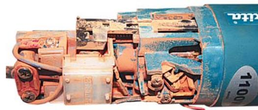
**Выход из строя выключателя**, отсутствие включения, регулировки оборотов. Наличие на корпусе выключателя строительной пыли и отходов обрабатываемого материала.
