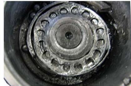
**Попадание воды в корпус привода толкателей насоса высокого давления.**
