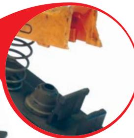
**Выход из строя выключателя** вследствие механического повреждения.
