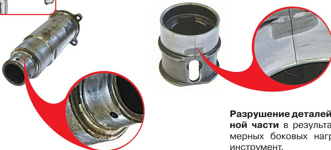
**Разрушение деталей ствольной части** в результате чрезмерных боковых нагрузок на инструмент.
