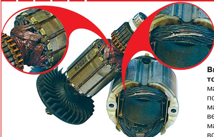
**Выход из строя ротора и статора** вследствие перегрева машины, который был вызван повышенным загрязнением машины, нарушением условий вентиляции для охлаждения машины, перегрузкой машины во время эксплуатации.
