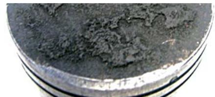
**Повреждения поршня.** Большое количество нагара из-за использования некачественной топливной смеси и эксплуатации инструмента с поврежденным или с отсутствующим воздушным фильтром.
