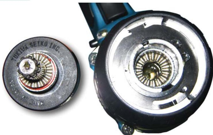
**Шпиндель с кулачковым патроном выходит из корпуса редуктора шуруповерта** вследствие недостаточной фиксации стопорного кольца. при условии отсутствия повреждений корпусных деталей и патрона.
