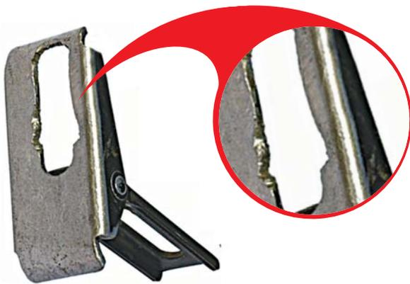
**Механическое повреждение ограничительного упора** в результате чрезмерного давления на инструмент при работе.
