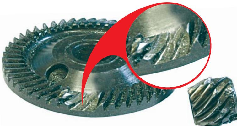
**Повреждение зубьев шестерни** вследствие воздействия ударной динамической нагрузки. Например, при резком заклинивании диска в материале или использовании поврежденного диска. Неправильное откручивание прижимной гайки после заклинивания диска. Нажатие фиксатора шпинделя диска во время работы.
