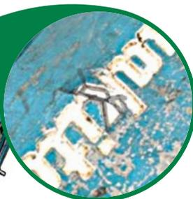
**Повреждения корпуса шатуном** вследствие разрушения подшипников в редукторе при соблюдении правил эксплуатации и отсутствия перегрузки инструмента.
