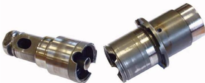
**Повреждение держателя инструмента** в месте проточки под стопорное кольцо улавливателя бойка. При отсутствии следов перегрузки и неправильной эксплуатации (износ ствола в форме эллипса)
