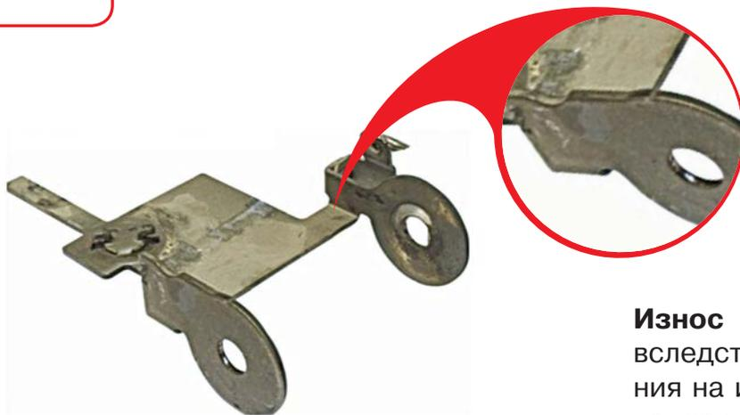
**Износ ограничителя ленты** вследствие чрезмерного давления на инструмент при работе и неправильной регулировки положения ленты.
