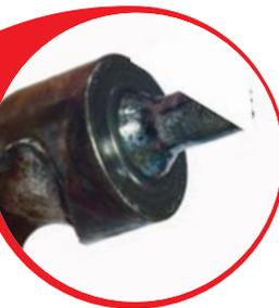
**Износ шпинделя.** Продолжительное использование инструмента без технического обслуживания. Работа инструментом, имеющий повреждения или износ деталей для защиты от попадания пыли.
