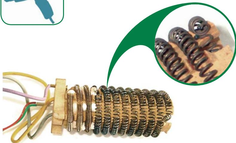
**Выход из строя нагревательного элемента,** обрыв спирали основного/предварительного нагрева. При условии отсутствия механических повреждений корпуса, сетевого кабеля и повышенного загрязнения внутри корпуса инструмента.
