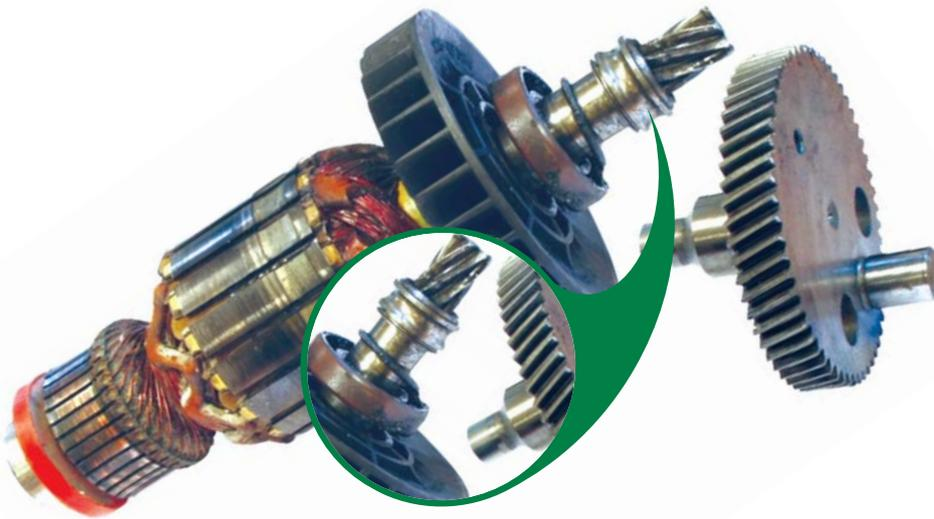
**Повреждение (не износ) зубьев** в паре шестерен вследствие разрушения подшипника. При условии отсутствия следов перегрузки и неправильной эксплуатации.
