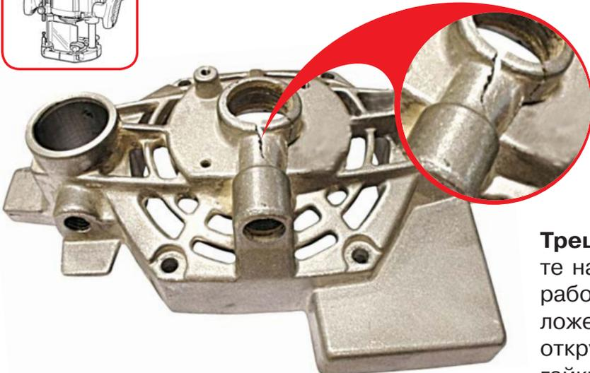
**Трещина в корпусе** в результате нажатия стопора вала во время работы инструмента или при приложении чрезмерных усилий при откручивании или закручивании гайки цапги.
