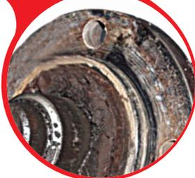
**Износ внутренней части держателя насадок** вследствие попадания грязи в инструмент через поврежденный сальник. Несоблюдение руководства по эксплуатации.
