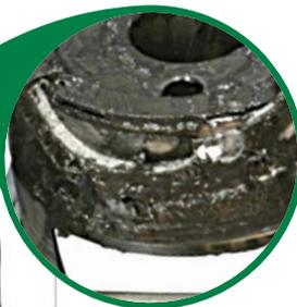
Повреждения в следствие разрушения подшипников редуктора при условии отсутствия следов перегрузки и нарушения условий эксплуатации.
