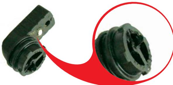
**Повреждение переключателя** вследствие нарушений условий эксплуатации, переключение режимов при работе инструмента.
