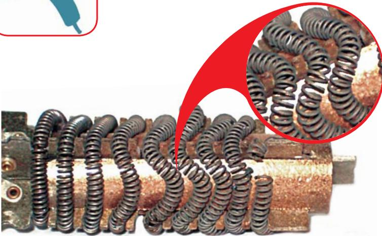
**Выход из строя нагревательного элемента**, разрушение основной спирали нагрева вследствие нарушений условий эксплуатации, механических ударов, перегрева инструмента.
