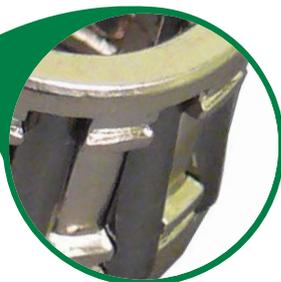
**Разрушение игольчатого подшипника** при условии отсутствия признаков неправильной эксплуатации инструмента
