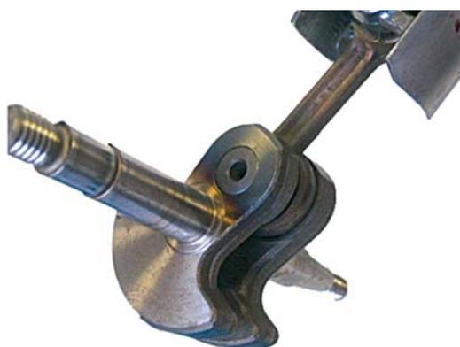
**Повреждение шатуна коленчатого вала, выход из строя подшипников** вызванные работой на повышенных оборотах или отсутствием смазки (несоответствующая техническим условиям топливная смесь).
